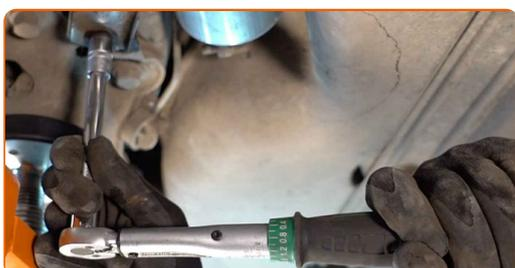
**19** Atornille la tapa de la válvula de control de presión.
