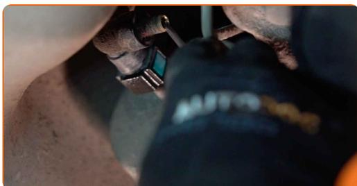
**9** Apriete los clips y separe las líneas de suministro de combustible de la carcasa del filtro de aceite. Utilice alicates para conectores de tubos de combustible. Use una palanca.
