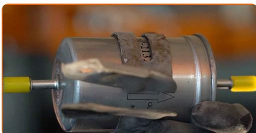
**15** Instale el filtro de combustible nuevo junto con el soporte.
