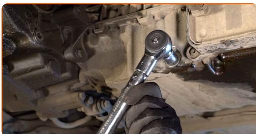
**23** Limpie el área del orificio de drenaje de la bandeja de aceite. Utilice un spray de limpieza multiuso.
