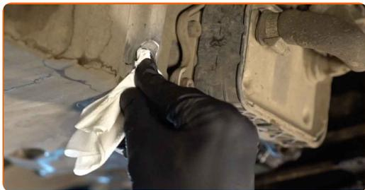
**22** Atornille en el nuevo tapón de drenaje y apriételo. Use un vaso de impacto del n.º 15. Utilice una llave dinamométrica. Apriételo a un par de torsión de 38 Nm.
