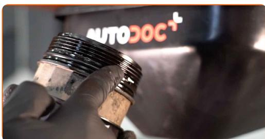
**20** Atornille el filtro nuevo en su sitio. Utilice el vaso 86/14-F. Utilice una llave dinamométrica. Apriételo a un par de torsión de 25 Nm.
