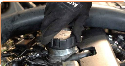
**31** Pongan en marcha el motor por unos minutos. Después de que se apague la luz de advertencia de presión del aceite, detenga el motor.
