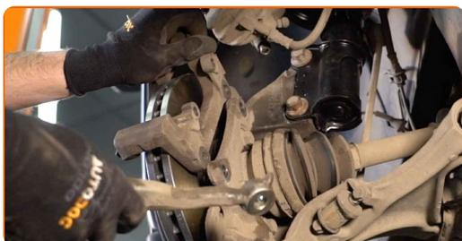
**24** Apriete la fijación de la pinza del cáliper de freno. Use un vaso de impacto del n.º 15. Utilice una llave dinamométrica. Apriételo a un par de 100 Nm.
