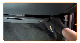
Desatornille las sujeciones de la cubierta de la carcasa del filtro de habitáculo. Utilice Torx T20. Utilice una llave de trinquete.
