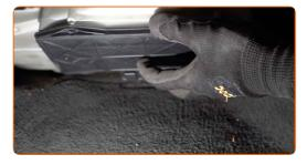
Atornille las sujeciones de la cubierta de la carcasa del filtro de habitáculo. Utilice Torx T20. Utilice una llave de trinquete.
