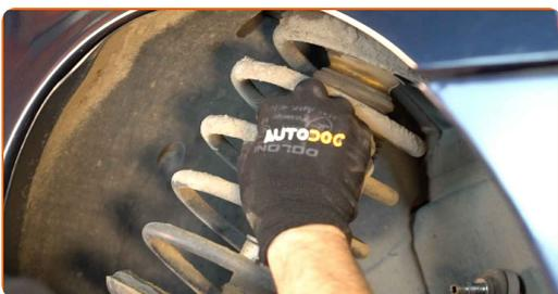
**20** Instale la pata amortiguadora en el mecanismo para apretar los resortes.
