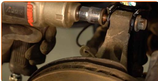
**47** Apriete las sujeciones inferiores que conectan el amortiguador con la mangueta de dirección. Usa una llave mixta del n.º 18. Use un vaso de impacto del n.º 21. Utilice una llave dinamométrica. Apriételo a un par de 105 Nm.+60°
