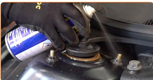
**4** Afloje la sujeción superior del soporte del amortiguador. Use un vaso de impacto del n.º 13. Utilice una llave de trinquete.
