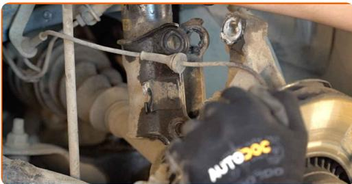
**18** Destornille la fijación superior de la cazoleta de la pata amortiguadora.
