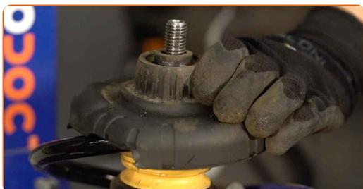
**36** Atornille la sujeción del soporte del puntal de suspensión. Use Vaso HEX No. H6. Utilice una llave de trinquete. Use alicates de bomba de agua.
