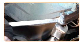
Apriete la tuerca de fijación que conecta el extremo de la barra de acoplamiento a la mangueta de dirección. Use un vaso de impacto del n.º 18. Utilice una llave dinamométrica. Apriételo a un par de 65 Nm.
