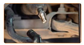
Trate la parte roscada de la barra de acoplamiento de dirección. Use grasa de cobre.
