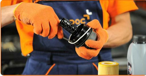
**18** Instale el nuevo filtro de aceite en el asiento de montaje de la cubierta del filtro.
