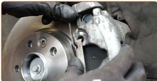
**23** Trate la superficie donde el disco del freno entra en contacto con la llanta de la rueda. Utilice grasa cerámica.
