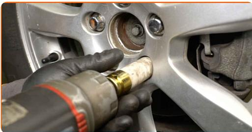
**27** Baje el automóvil y, manteniendo el orden cruzado, apriete los pernos de fijación de las ruedas. Utilice una llave de impacto para llanta # 19. Utilice una llave dinamométrica. Apriételo a un par de 140 Nm.
