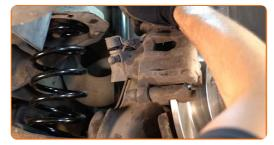
Instale el resorte de fijación del cáliper de freno. Utilice un mazo de goma.
