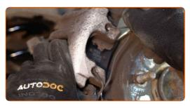
Retire el soporte de freno. Use una palanca.
