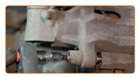
Separe el muelle de retención de la pinza de freno. Use una palanca.
