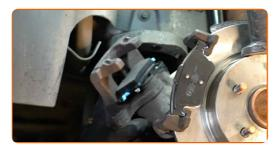
Sustitución: pastillas de freno - VOLVO V40 Furgón / Hatchback (525, 526).
