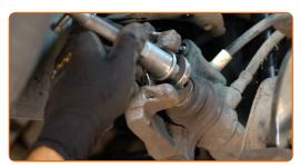
Trate las pastillas de freno en el área donde su superficie entra en contacto con el soporte de la pinza de freno.
