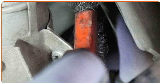
**6** Afloje las sujeciones del filtro de combustible. Utilice Torx T30. Utilice una llave de trinquete.
