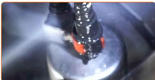
**8** Desconecte las líneas de suministro de combustible del filtro de combustible. Utilice un destornillador plano.
