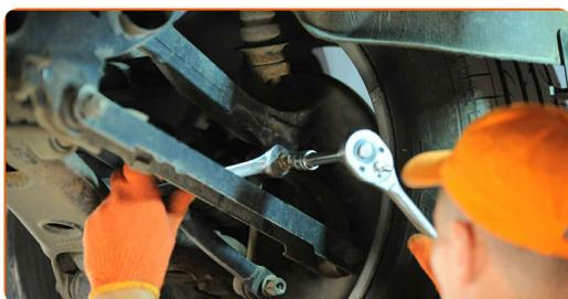
**5** Retire el perno de sujeción.
