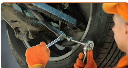
**4** Desatornille la sujeción que conecta la bieleta de barra estabilizadora con el brazo de control. Usa una llave mixta del n.º 18. Utilice Torx T40. Utilice una llave de trinquete.
