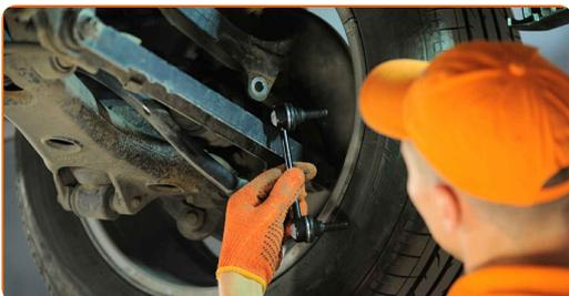
**9** Apriete la sujeción que conecta la bieleta a la barra estabilizadora. Usa una llave mixta del n.º 18. Utilice Torx T40. Utilice una llave dinamométrica. Apriételo a un par de 50 Nm.
