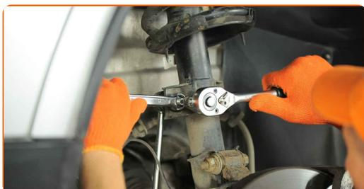
**46** Trate todas las juntas de la bieleta o enlace estabilizador. Trate las sujeciones del amortiguador. Use grasa de cobre.
