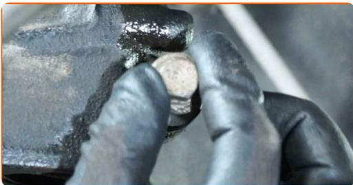
**59** Retire el apoyo de debajo de la mangueta de dirección.
