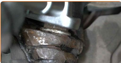
**71** Apriete la sujeción que conecta la bieleta de barra estabilizadora al amortiguador. Use un vaso de impacto del n.º 15. Utilice una llave dinamométrica. Apriételo a un par de 55 Nm.
