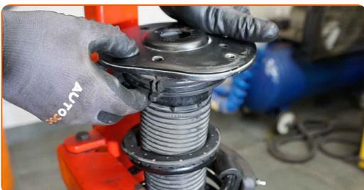
**48** Apriete la tuerca del vástago del pistón del puntal de suspensión. Vaso para tuerca de amortiguador de 18 mm. Use Vaso HEX No. H6. Utilice una llave dinamométrica. Apriételo a un par de 50 Nm.
