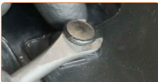
**4** Desplace la rejilla del capó a un lado para acceder a las sujeciones del soporte del puntal de suspensión.
