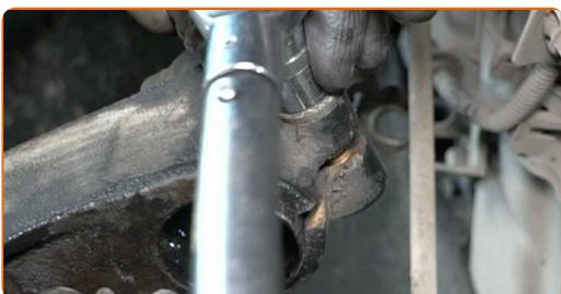
**70** Apriete la sujeción que conecta la rótula a la mangueta de dirección. Usa una llave mixta del n.º 21. Utilice una llave dinamométrica. Apriételo a un par de 110 Nm.
