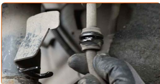
**14** Desconecte el cableado del sensor ABS.
