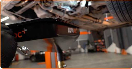
3 Destornille el tapón de desagüe. Use un vaso de impacto del n.º 17. Utilice una llave de trinquete.
