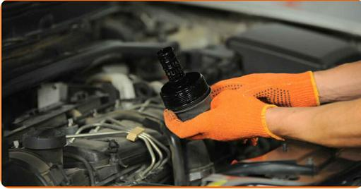
16 Retire la junta tórica de la tapa del filtro de aceite. Utilice un destornillador plano.
