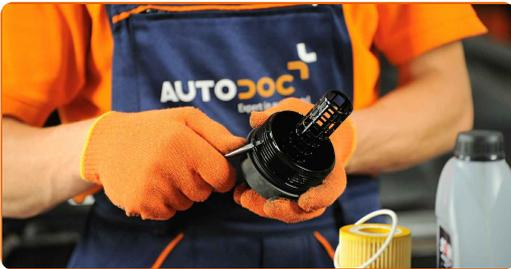
17 Instale una nueva junta tórica en el asiento de montaje de la cubierta del filtro. Utilice un destornillador plano.
