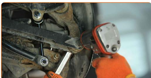
**16** Retire el perno de sujeción.
