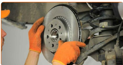
**33** Apriete la fijación del disco de freno. Usa una llave mixta del n.º 10. Utilice una llave dinamométrica. Apriételo a un par de 11 Nm.
