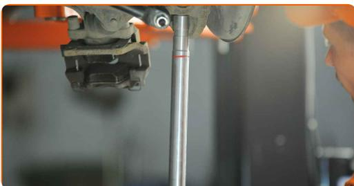
**29** Apriete las sujeciones que conectan el brazo de control a la mangueta trasera. Usa una llave mixta del n.º 18. Use un vaso de impacto del n.º 15. Utilice una llave dinamométrica. Apriételo a un par de 80 Nm.
