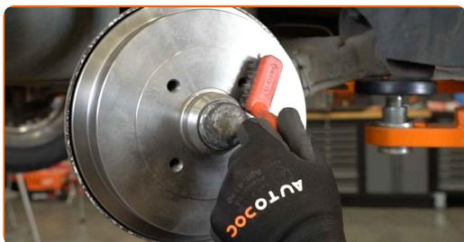
**31** Trate la superficie en la cual la llanta de la rueda entra en contacto con el tambor del freno. Use grasa de cobre.
