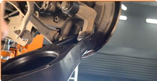
Sustitución: brazo de control inferior de la suspensión trasera - VW Beetle Cabrio (5C7, 5C8). Consejo:
