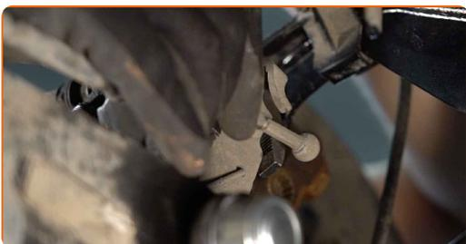
**15** Presione la palanca del actuador del freno de estacionamiento (freno de mano) en la pinza de freno.
