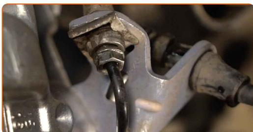
**29** Instale el clip de retención del latiguillo de freno. Utilice un mazo de goma.
