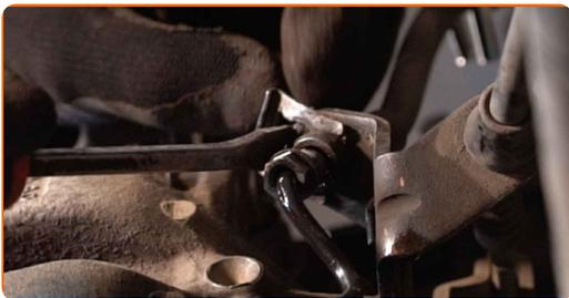
**14** Retire el clip de sujeción del cable del freno de estacionamiento. Use una palanca.
