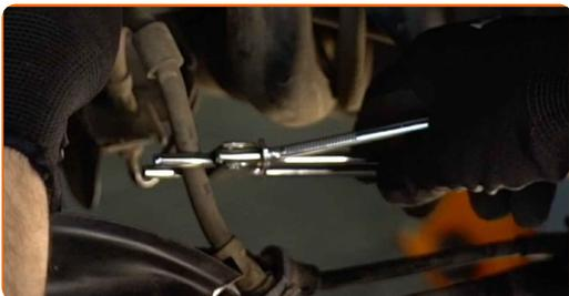
**30** Retire la abrazadera del latiguillo del freno.
