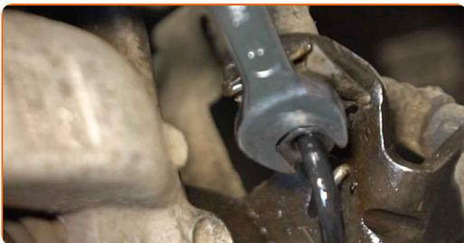
**10** Sujete el latiguillo del freno con una abrazadera de latiguillo de freno.
