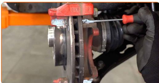
Sustitución: pastillas de freno - VW Beetle Hatchback (5C1, 5C2). Consejo de AUTODOC:
