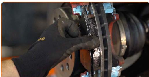
Sustitución: pastillas de freno - VW Beetle Hatchback (5C1, 5C2). Consejo:
