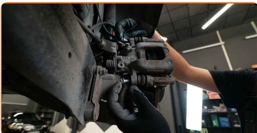
Sustitución: pastillas de freno - VW Beetle Hatchback (5C1, 5C2). Consejo de los expertos de AUTODOC:
