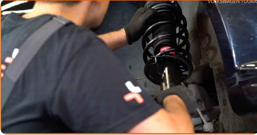
48 Apriete la fijación superior de la pata amortiguadora. Use un vaso de impacto del n.º 13. Utilice una llave de trinquete.
