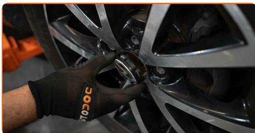
62 Baje el automóvil y, manteniendo el orden cruzado, apriete los pernos de fijación de las ruedas. Utilice una llave dinamométrica. Apriételo a un par de 120 Nm.
