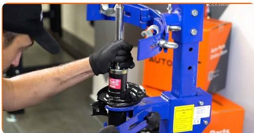
40 Instale el guardapolvo y el tope en el amortiguador nuevo.
