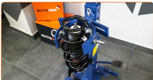
43 Instale el soporte de montaje superior del puntal y el cojinete del soporte de montaje del puntal.
