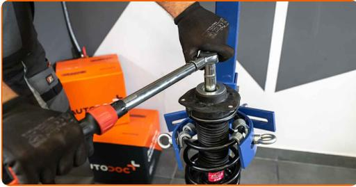
Sustitución: amortiguador telescópico - VW Beetle Hatchback (5C1, 5C2). Los expertos de AUTODOC recomiendan:
