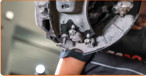
52 Atornille las fijaciones de la placa de bloqueo de la rótula (3 piezas). Use un vaso de impacto del n.º 16. Utilice una llave dinamométrica. Apriételo a un par de 60 Nm.
