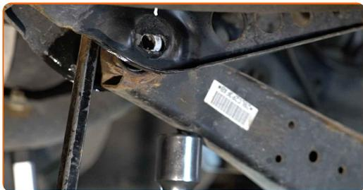
**21** Instale el perno de sujeción.
