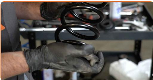
**18** Instale el resorte helicoidal junto con los soportes de montaje de goma en los asientos de montaje.
