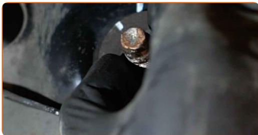
**23** Atornille la sujeción que une el brazo de control al subchasis. Use un vaso de impacto del n.º 18. Utilice una llave de trinquete.
