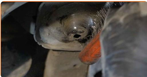
**17** Instale el espaciador de caucho en el nuevo muelle helicoidal.
