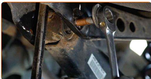
**22** Ajuste la posición del perno de alineación según la marca.
