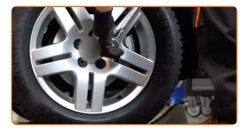
Atornille la atadura superior del soporte del mostrador del amortizador. Usa una llave mixta del n.º 22. Use Vaso HEX No. H7. Utilice una llave dinamométrica. Apriételo a un par de 60 Nm.
