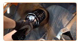
Atornillen la fijación superior de la cazoleta de la pata amortiguadora. Use un vaso de impacto del n.º 13. No lo apriete.
