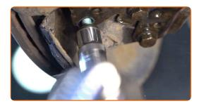
Desenrosque la fijación que conecta el eje de transmisión al cubo de la rueda. Utilice un vaso 12 puntos nº 30.
