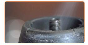
Destornille la tuerca de la varilla de la pata amortiguadora. Use un vaso de impacto del n.º 21. Use Vaso HEX No. H7. Utilice una llave de trinquete.
