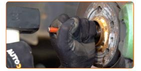
Sostenga el muñón de dirección. Utilice un gato de transmisión hidráulica.
