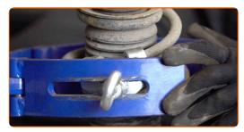
27 Trate la varilla del amortiguador. Use un cepillo de alambre. Use el aerosol WD-40.
