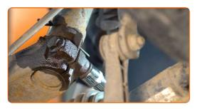
Retire el perno de sujeción.
