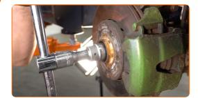
Trate las sujeciones del amortiguador. Trate todas las articulaciones del brazo. Use grasa de cobre.
