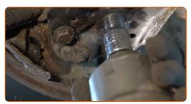
Apriete las sujeciones inferiores que conectan el amortiguador con la mangueta de dirección. Use un vaso de impacto del n.º 18. Usa una llave mixta del n.º 18. Utilice una llave dinamométrica. Apriételo a un par de 60 Nm.+90°
