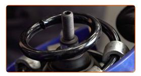
Instale el soporte de montaje superior del puntal y el cojinete del soporte de montaje del puntal.
