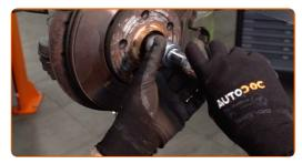
Tratar las acanaladuras de la junta homocinética del eje de transmisión. Use el aerosol WD-40.
