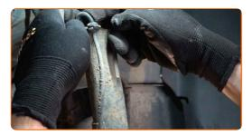
12.1 Limpie las sujeciones que conectan el puntal amortiguador a la mangueta de dirección.
