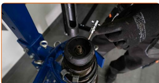
**26** Retire el soporte del puntal amortiguador.
