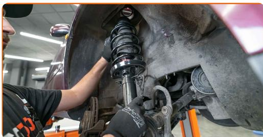
**33** Apriete la fijación superior de la pata amortiguadora.
