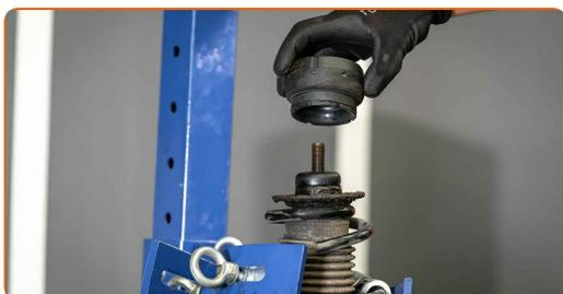
**27** Limpie el asiento de montaje del soporte del puntal amortiguador. Use un cepillo de alambre.
