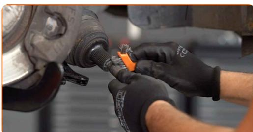
**35** Fije la pata amortiguadora en el muñón de dirección.
