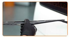
Gire la escobilla del limpiaparabrisas a 90 grados. Retire la escobilla del brazo del limpiaparabrisas.
