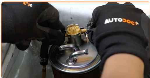
**13** Instale el clip de retención de la línea de combustible.
