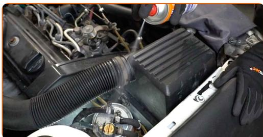
**4** Debilite la fijación del filtro de combustible. Use un vaso de impacto del n.º 13. Utilice una llave de trinquete.
