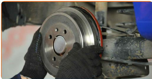
**20** Apriete las sujeciones del tambor del freno. Utilice un destornillador Phillips. Utilice una llave dinamométrica. Apriételo a un par de 4 Nm.
