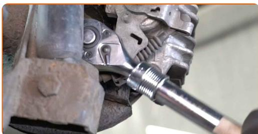
**11** Suelte el cable del freno de estacionamiento. Use alicates de bomba de agua. Use una palanca.
