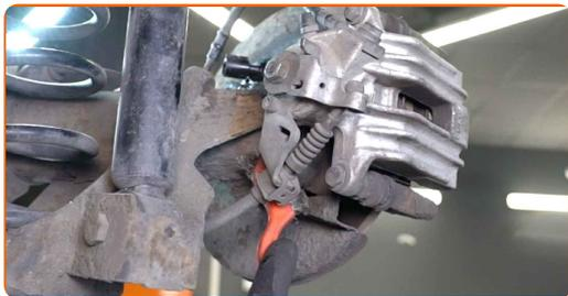
**10** Desenrosque las sujeciones del soporte de la pinza de freno. Use Vaso HEX No. H8. Utilice una llave de trinquete. Utilice una llave giramachos.
