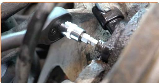
**9** Limpie las sujeciones del soporte de la pinza del freno. Use un cepillo de alambre. Use el aerosol WD-40.
