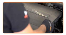
Cubra el cuerpo del acelerador con una toalla de microfibra para evitar que el polvo y la suciedad penetren en el sistema.
