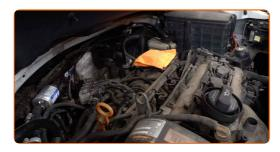
Desconecte el manguito de ventilación del cárter del tubo de llenado de aceite.
