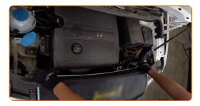
Separe el manguito de ventilación del cárter de la cubierta del motor en la izquierda.
