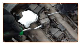
Desenrosque las lengüetas de bloqueo de plástico del conector de la bobina de encendido (bobina de ignición).
