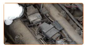
Saque la bobina de ignición del pozo de la bujía.
