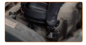
Fije el manguito de ventilación del cárter al tubo de llenado de aceite.
