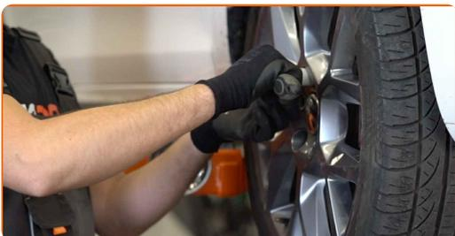
**24** Baje el automóvil y, manteniendo el orden cruzado, apriete los pernos de fijación de las ruedas. Utilice una llave dinamométrica. Apriételo a un par de 120 Nm.
