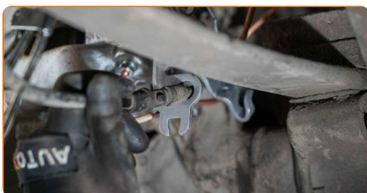
**31** Retire la abrazadera del latiguillo del freno.
