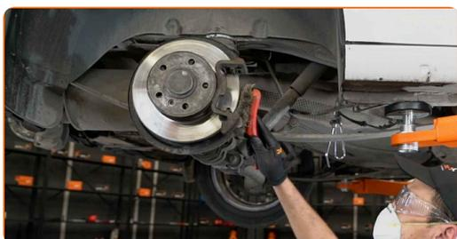
Sustitución: pinza de freno - VW Caddy III Furgón (2KA, 2KH, 2CA, 2CH).
