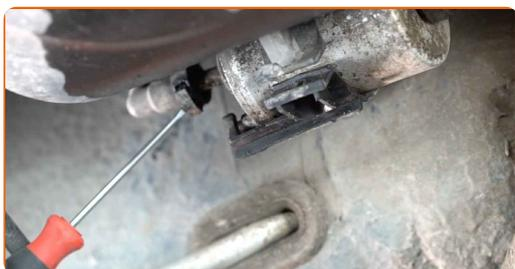
Sustitución: filtro de combustible - VW Caddy III Furgón (2KA, 2KH, 2CA, 2CH).
