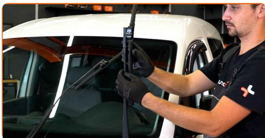
5 Gire la escobilla del limpiaparabrisas a 90 grados. Retire la escobilla del brazo del limpiaparabrisas.
