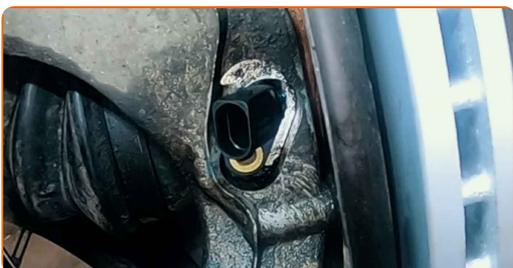
**13** Apriete la sujeción que conecta el sensor ABS con la mangueta de dirección. Use Vaso HEX No. H5. Utilice una llave dinamométrica. Apriételo a un par de 7 Nm.
