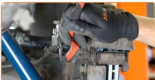
**9** Desenrosque las sujeciones de la pinza de freno. Use un vaso de impacto del n.º 12. Utilice una llave de trinquete.
