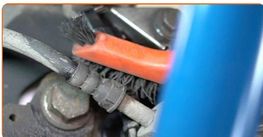
**13** Sujete el latiguillo del freno con una abrazadera de latiguillo de freno.
