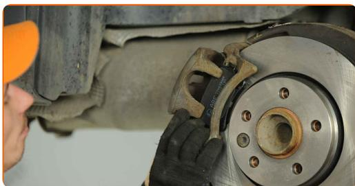
**Sustitución: pinza de freno - VW California T5 Bus (7EC, 7EF, 7EG, 7HF).
