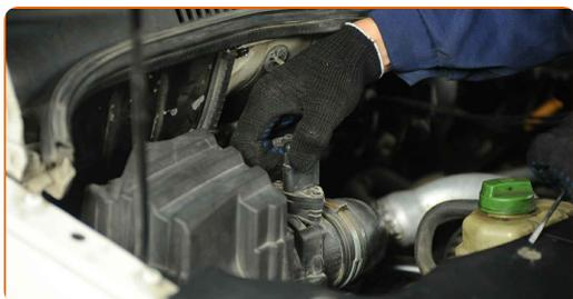
**4** Suelte la abrazadera del manguito de admisión de aire. Utilice alicates para abrazaderas clic-R.
