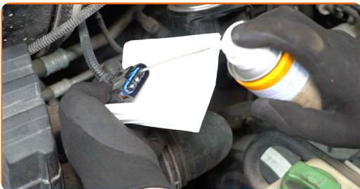
**18** Enchufe el conector del sensor de flujo de aire.
