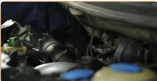
**15** Presione los clips de la cubierta del filtro de aire en su lugar.
