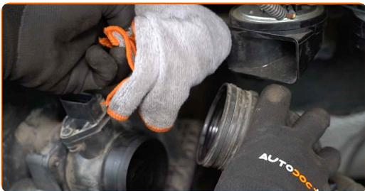
**13** Instale la tapa del filtro de aire. Fijela.
