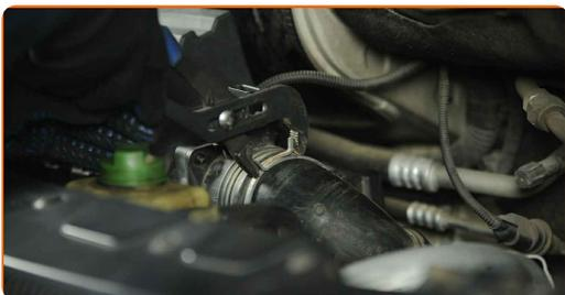
**17** Trate el conector del sensor de flujo de masa de aire. Utilice grasa dieléctrica.
