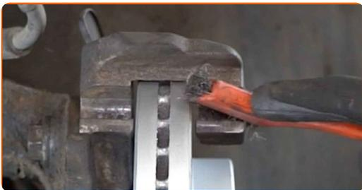
**15** Trate el pistón de la pinza de freno. Utilice un cepillo de limpieza de nylon. Use un limpiador de frenos.
