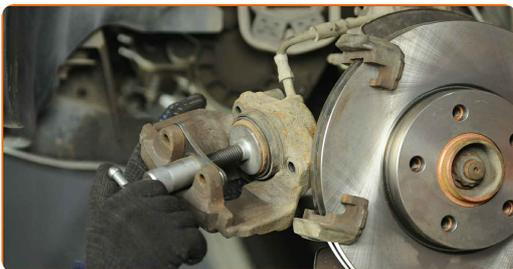
**17** Trate las pastillas de freno en el área donde su superficie entra en contacto con el soporte de la pinza de freno. Use pasta antichirridos.
