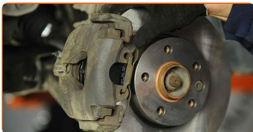
**25** Trate la superficie donde el disco del freno entra en contacto con la llanta de la rueda. Utilice grasa cerámica.
