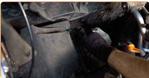
**9** Destornille los bulones de fijación del cuerpo del filtro. Use Vaso HEX No. H5.
