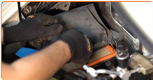
**11** Saque de la carcasa del filtro el elemento filtrante de recambio.
