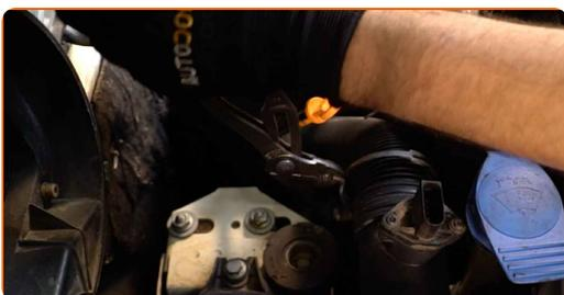
**8** Suelte los clips de la cubierta del filtro de aire.
