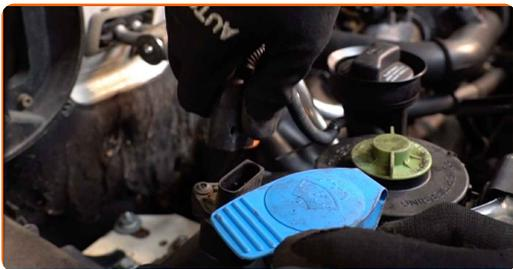
**6** Desconecte el depósito de la dirección asistida.
