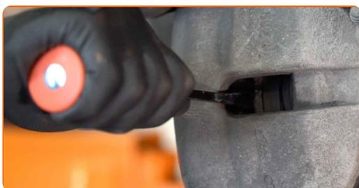
**14** Mediante el destornillador plano saque el resorte de fijación del cáliper de freno.
