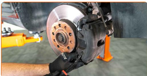
**15** Destornille la fijación del cáliper de freno. Use Vaso HEX No. H7.
