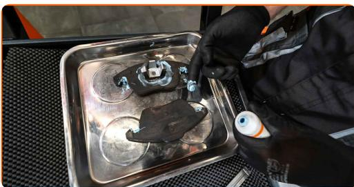
**22** Instale la pinza del freno junto con las pastillas de freno.
