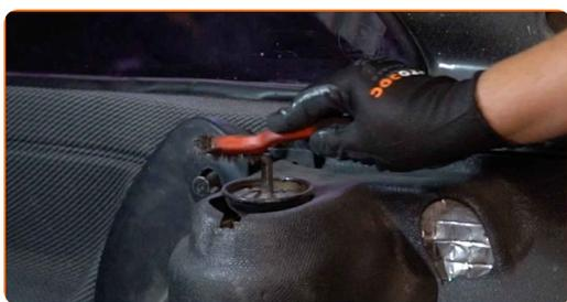
**3** Afloje la sujeción superior del soporte del amortiguador. Use una llave mixta del n.º 17. Utilice un vaso para amortiguador DDNº6. Utilice una llave de trinquete.
