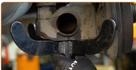
**20** Instale el perno de sujeción.
