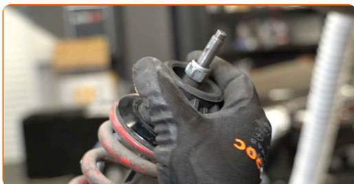
**18** Instale la pata amortiguadora en el arco de la rueda.
