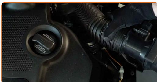
**15** Fije la abrazadera en el manguito de admisión de aire. Use alicates de bomba de agua.
