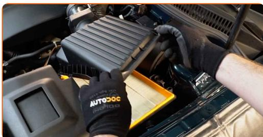
**8** Saque de la carcasa del filtro el elemento filtrante de recambio.
