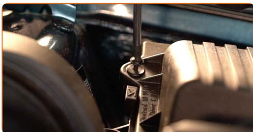
4 Suelte la abrazadera del manguito de admisión de aire. Use alicates de bomba de agua.
