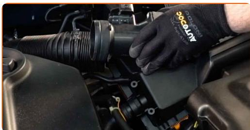
**7** Levante ligeramente la cubierta de la carcasa del filtro de aire.
