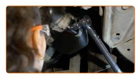
Limpie el área del orificio de drenaje de la bandeja de aceite. Utilice un spray de limpieza multiuso.
