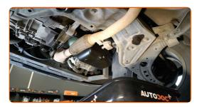
Limpie el área del orificio de drenaje de la bandeja de aceite. Use un cepillo de alambre. Utilice un spray de limpieza multiuso.
