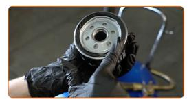
Atornille el filtro nuevo en su sitio. Use un vaso de impacto del n.º 30. Utilice una llave dinamométrica. Apriételo a un par de 26 Nm.
