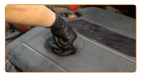
Pongan en marcha el motor por unos minutos. Después de que se apague la luz de advertencia de presión del aceite, detenga el motor.
