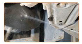
Destornille el tapón de desagüe. Use un vaso de impacto del n.º 19. Utilice una llave de trinquete.
