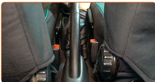
**2** Suelte el cable del freno de mano. Usa una llave mixta del n.º 10.
