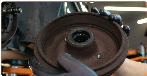
**13** Limpie el asiento de montaje del cojinete del cubo (buje). Utilice un spray de limpieza multiuso.
