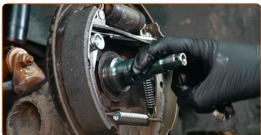
**15** Instale el nuevo tambor de freno ensamblado junto con el cojinete del cubo de rueda.
