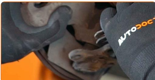
**28** Separe el eje de transmisión de la mangueta de dirección.
