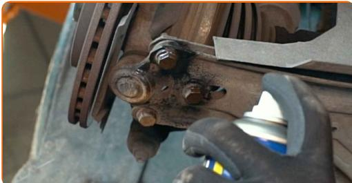
**26** Desenrosque la fijación que conecta la rótula al brazo de control de la suspensión. Use un vaso de impacto del n.º 13. Utilice una llave de trinquete.
