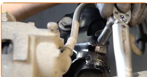
**42** Trate las sujeciones del amortiguador. Use grasa de cobre.
