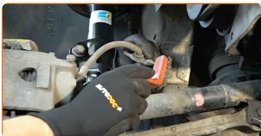
**40** Fije el soporte de fijación del latiguillo de freno.
