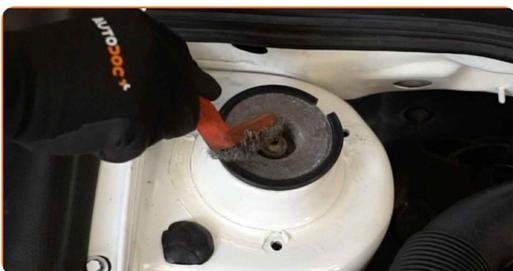
**4** Afloje la sujeción superior del soporte del amortiguador. Use Vaso HEX No. H6. Use un vaso de impacto del n.º 21. Utilice una llave de trinquete.
