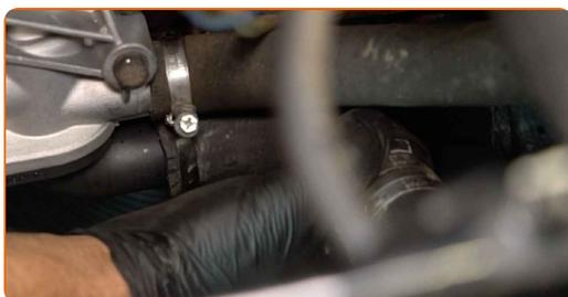
**15** Asegure la abrazadera de la manguera de refrigerante. Use un vaso de impacto del n.º 7. Utilice una llave de trinquete.
