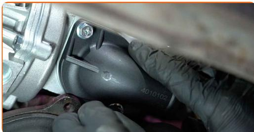
**13** Apriete las sujeciones de la carcasa del termostato. Use un vaso de impacto del n.º 10. Utilice una llave dinamométrica. Apriételo a un par de 13 Nm.
