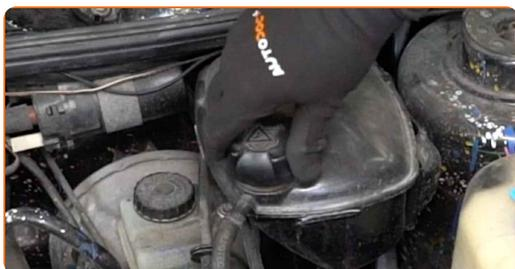
22 Enrosque la tapa del depósito de refrigerante.
