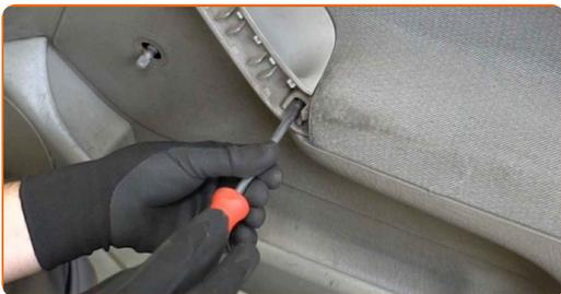
**5** Separe el mango de ajuste del espejo retrovisor.
