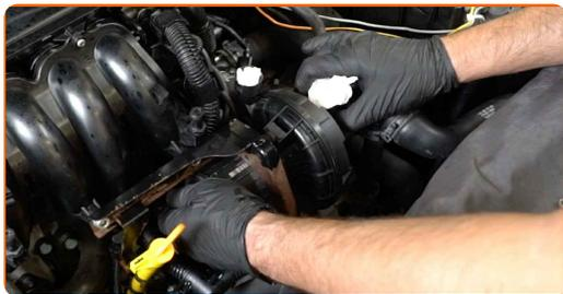
**23** Atornille las sujeciones que conectan la bomba de aire secundario a su soporte. Usa una llave mixta del n.º 10.
