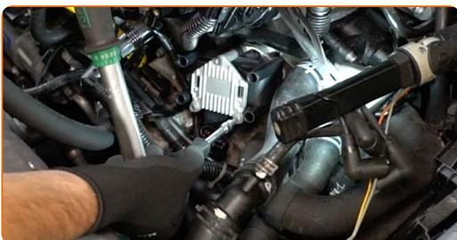
**18** Enchufe el conector de la bobina de encendido.
