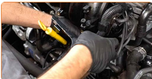
**21** Apriete la sujeción del soporte de la bomba de aire secundario. Use Vaso HEX No. H6. Use un vaso de impacto del n.º 13. Utilice una llave dinamométrica. Apriételo a un par de 9 Nm.
