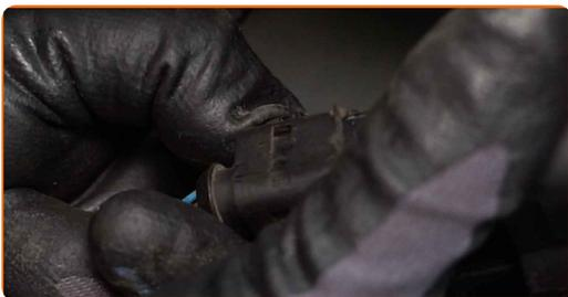
**26** Retire el cable de bloqueo de la manija. Utilice una herramienta de recorte de plástico.
