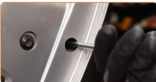
**22** Retire la cubierta de la sujeción exterior de la manija de la puerta. Utilice una herramienta de recorte de plástico.
