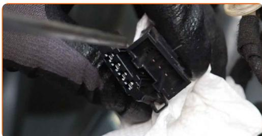
**47** Trate el conector del módulo del interruptor del elevavinas eléctrico. Utilice grasa dieléctrica.
