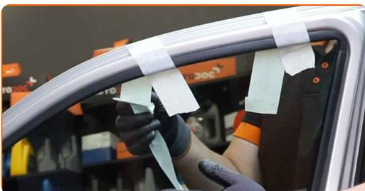
**56** Baje el vidrio de la ventana e instálelo en su asiento de montaje en el mecanismo del elevavinas.
