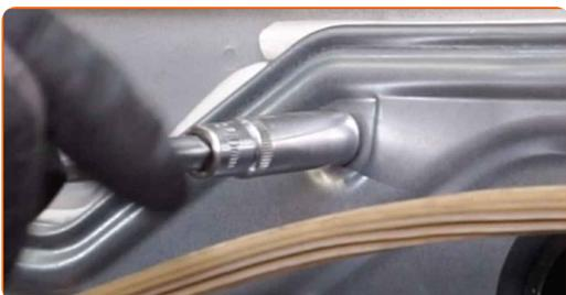
**42** Instale las cubiertas del panel de la puerta.
