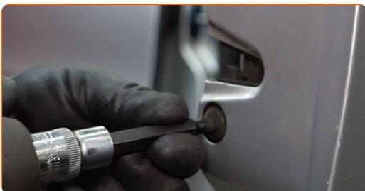
**24** Retire el panel de la puerta junto con el varillaje del regulador de la ventana.
