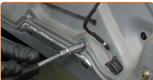
**21** Desenrosque la sujeción exterior de la manija de la puerta. Utilice Torx T20. Utilice una llave de trinquete.
