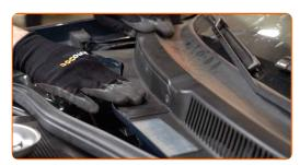
Atornille las sujeciones de la cubierta de la carcasa del filtro de habitáculo. Utilice un destornillador Phillips.
